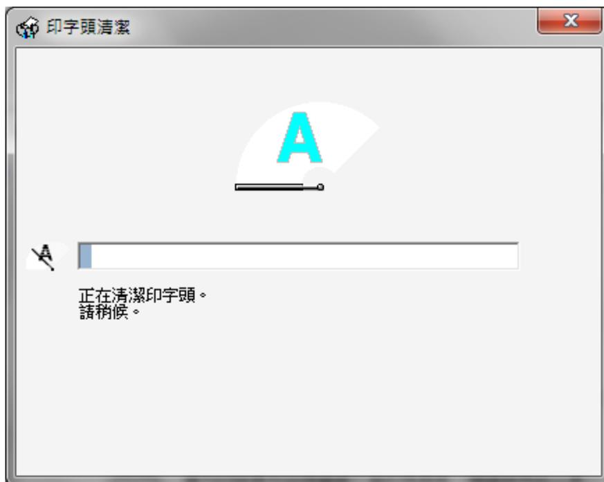
步驟 8、待清潔動作完成後，點選「列印噴嘴檢查表單」，若噴嘴檢查四色線條仍不完整，建議您重覆操作清潔 2 次，如噴嘴檢查四色線條正常，則請點選完成。
