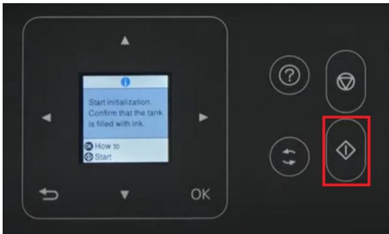
**步驟 4**：初始化墨水約需 11 分鐘，設定過程中請勿關機、拔除電源線、打開文件上蓋。
