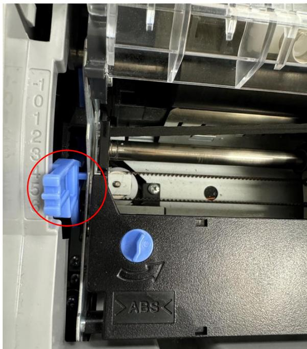
**步驟 3：**請參照下表，依照所使用的紙張種類，調整紙張厚度調整桿的位置。
