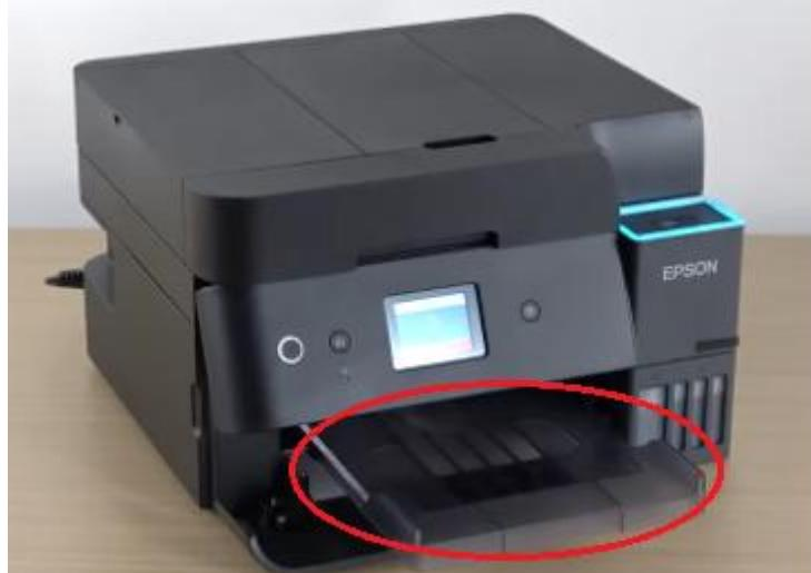
步驟 1：請按下印表機液晶面板上的 圖示（下圖紅框處），即可收起出紙托盤。
