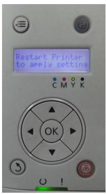
步驟 16: 所有設定都完成後,煩請將機器關機後 5~10 秒重新開機啟動後,透過電腦端使用命令提示字元程式,去 PING 機器的 IP 位置是否正常連線,確認正常後,在煩請列印測試頁測試即可。
