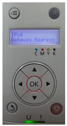
步驟 15:進入 Gateway Address 選單,請輸入 Gateway Address 的位置後,並按下 OK 鍵(1)後會出現 Restart 的訊息後,會在跳回 Gateway Address 設定畫面,此時在 Gateway Address 選項旁會出現\*圖示,表示設定完成,在按下返回鍵(2)回到 Network Mask 選單,如下圖。
