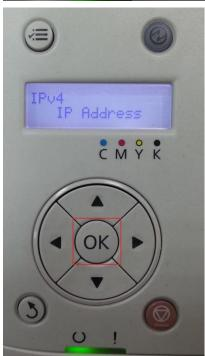
步驟 11:進入 IP Address 選單,請輸入 IP Address 的位置後,並按下 OK 鍵(1)後會出現 Restart 的訊息後,會在跳回 IP Address 設定畫面,此時在 IP Address 選項旁會出現\*圖示,表示設定完成,在按下返回鍵(2)回到 IP Address 選單,如下圖。
