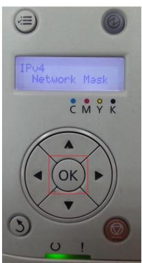
步驟 13:進入 Network Mask 選單,請輸入 Network Mask 的位置後,並按下 OK 鍵(1)後會出現 Restart 的訊息後,會在跳回 Network Mask 設定畫面,此時在 Network Mask 選項旁會出現\*圖示,表示設定完成,在按下返回鍵(2)回到 Network Mask 選單,如下圖。
