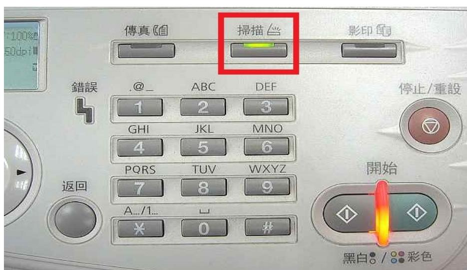
步驟 3、在雷射複合機的操作面板左邊上方的液晶面板顯示掃描選單，【SCAN TO(掃描至)】功能黑底白字，按液晶螢幕的下方的【Select(選擇)】按鍵確認。
