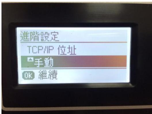
步驟 6、之後畫面會顯示印表機 IP 位址，請直接透過「◀」、「▶」移動游標，並透過面板數字鍵輸入要設定的 IP，輸入完成後按「OK」鍵繼續。(此圖以 192.168.11.62 為例)。
