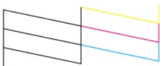
步驟 6、若有任何線條缺漏 (如下圖所示)，則表示噴嘴堵塞或印字頭未校正，請進行印字頭清潔。
