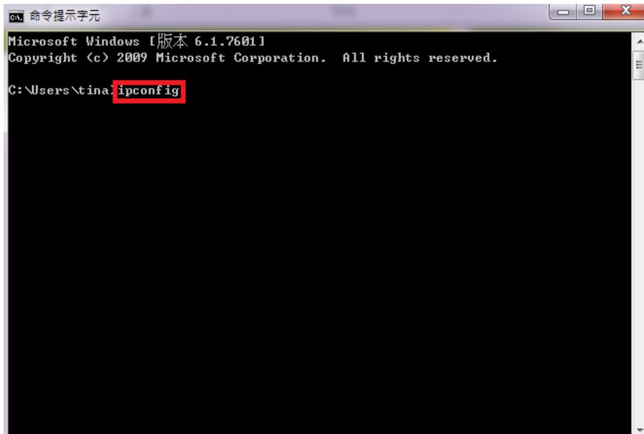
3. 確認電腦的 IPv4 位址並記下。(需確認印表機 IP 位址跟電腦 IP 位址在相同網段)
