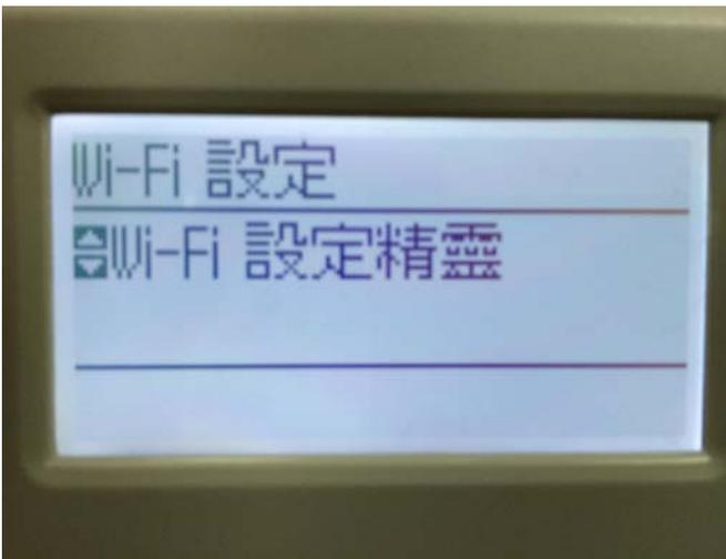
步驟 3、進入「Wi-Fi 設定精靈」，印表機就會開始搜尋同網段的 SSID。
