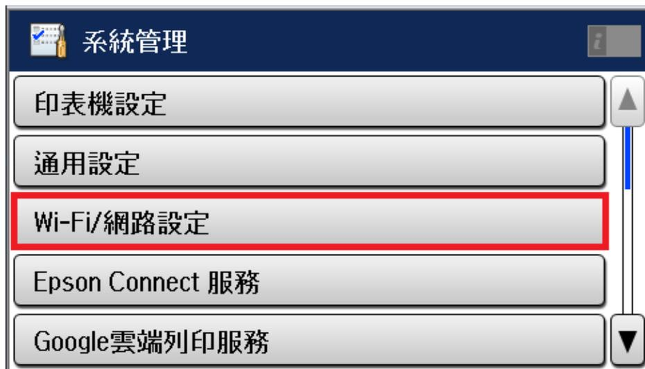
步驟 4、進入『Wi-Fi/網路設定』後，透過『▼』選擇『Wi-Fi 設定』。
