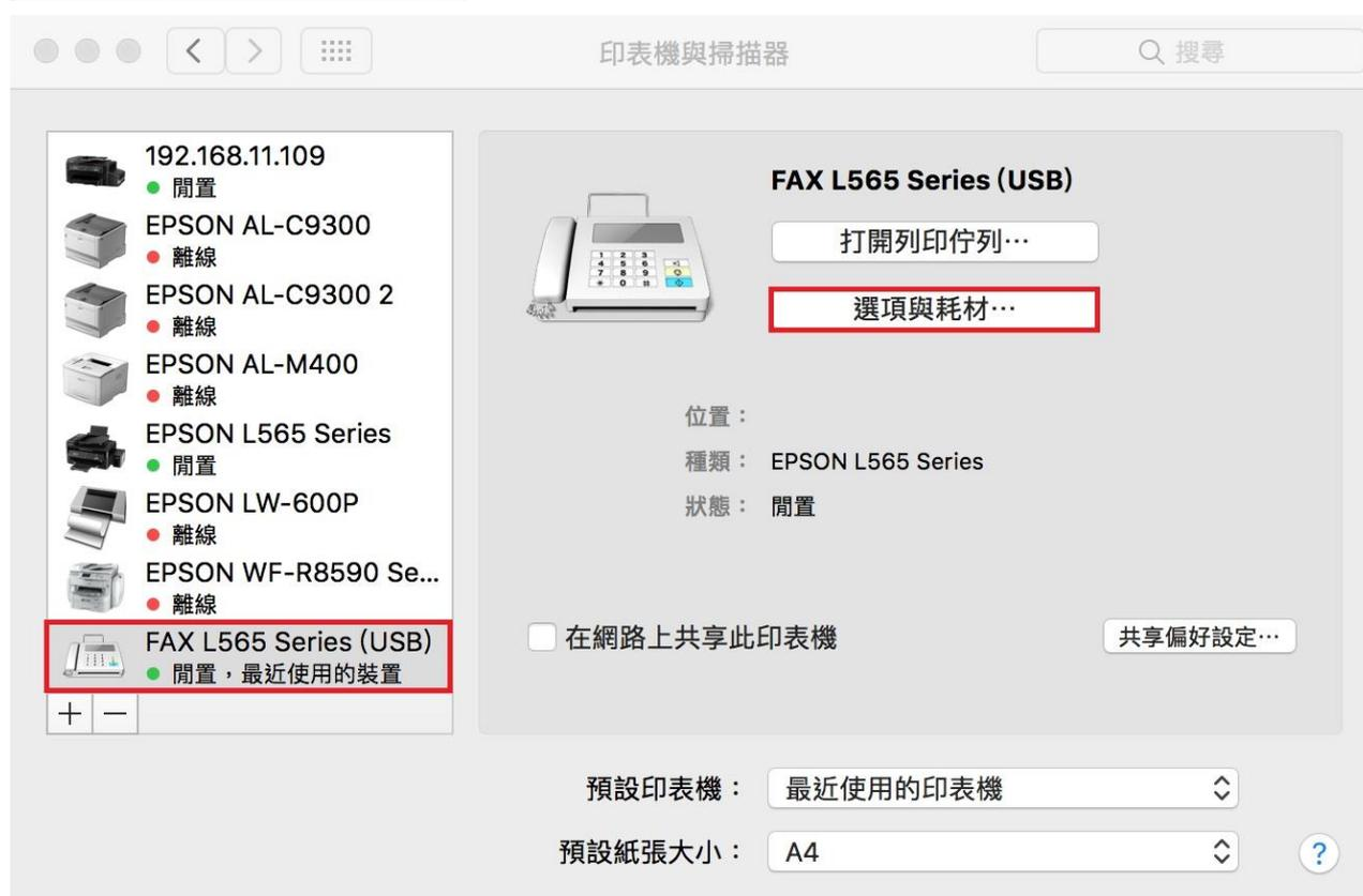
步驟 6、選擇「工具程式」，並點選「打開印表機工具程式」，即可開啟 Fax Utility 工具程式。
