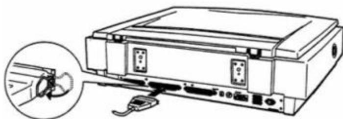
步驟 3、將電纜線的另一端連接在電腦或其他串連設備的 SCSI 介面上。
