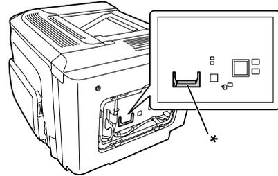
\* CompactFlash 記憶卡插槽
