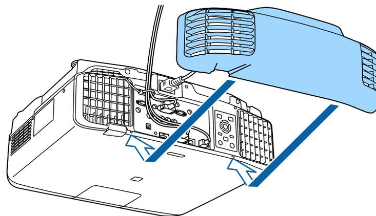
**3** 旋緊纜線蓋上的兩顆螺絲。(您可以用手指旋緊螺絲。)
