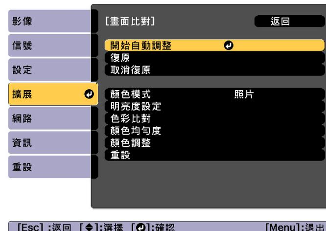
調整圖樣會顯示並開始調整。如果投影影像在調整之前顯示，則程序到此結束。
