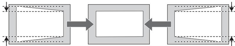
如果影像長寬比不正確，請使用**垂直平衡**和**水平平衡**調整影像平衡。
