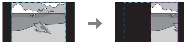
**完整顯示**：根據投影機的面板尺寸 (可以顯示影像的最大區域) 進行調整。
