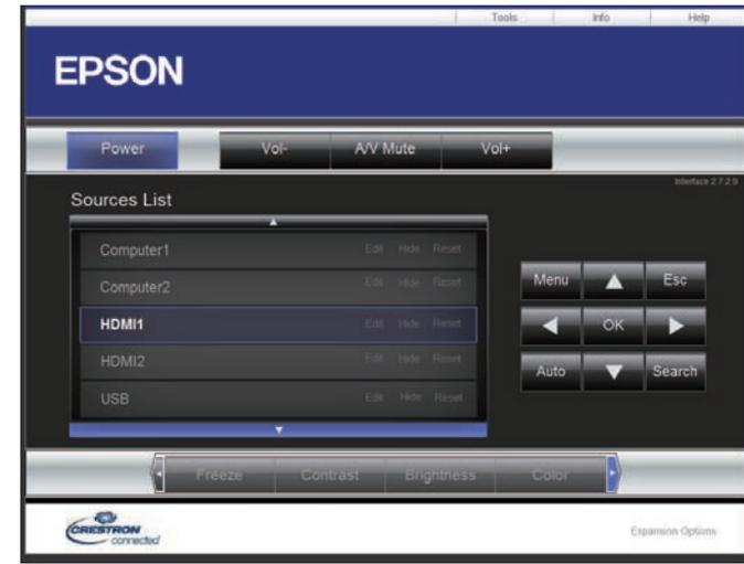
**4** 在 Sources List 方塊中選擇您要控制的輸入訊源。您可在方塊中使用向上和向下鍵捲動瀏覽可用的訊源。
