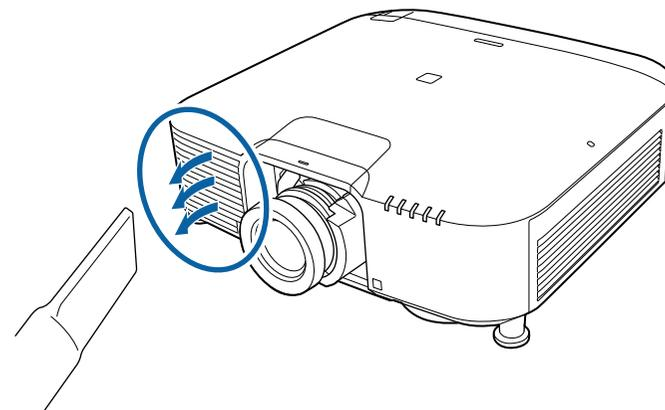
**3** 如圖所示，鬆開螺絲並拆下防塵濾網 (綁有繫繩)。
