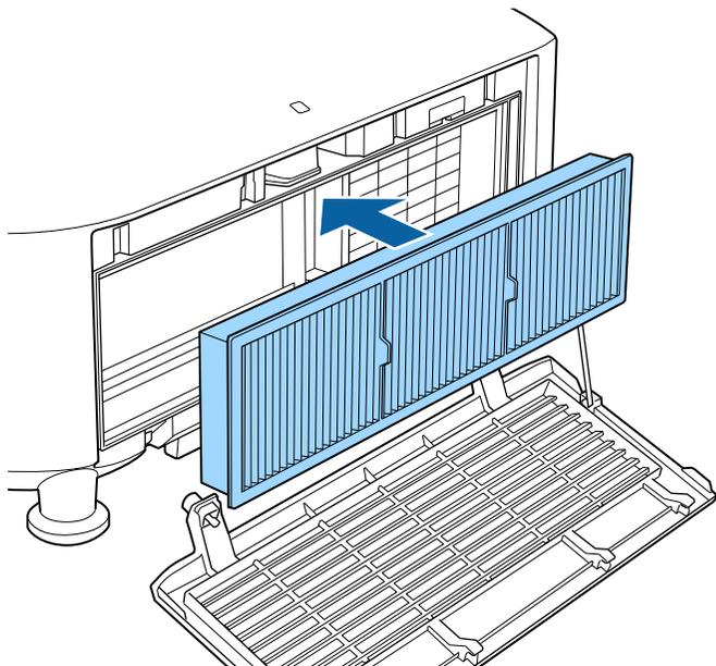
**8** 如圖所示，更換防塵濾網蓋並鎖緊螺絲。
