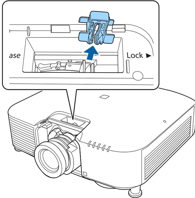
**5** 緊握鏡頭，同時抓緊鎖桿並移到 **Release** 位置。
