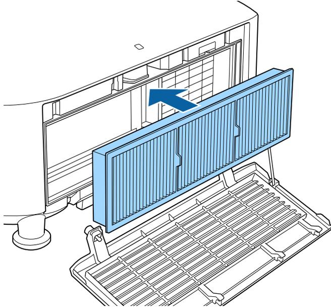
**5** 如圖所示，更換防塵濾網蓋並鎖緊螺絲。
