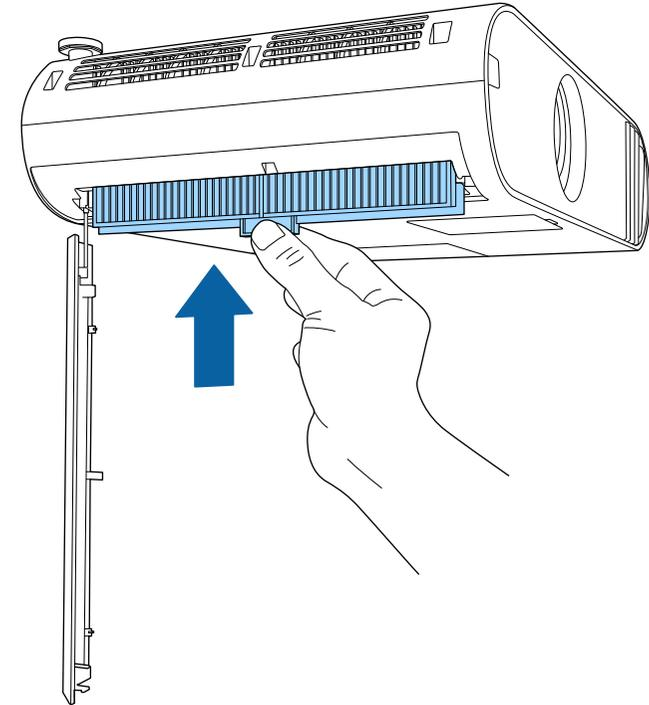
**5** 請用吸塵器清潔空氣濾網的兩側，清除殘留的灰塵。
