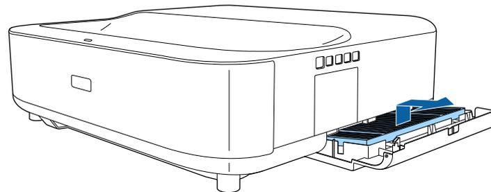
**4** 請用吸塵器清潔防塵濾網的正面 (含有凸片的一側)，去除殘留的灰塵。
