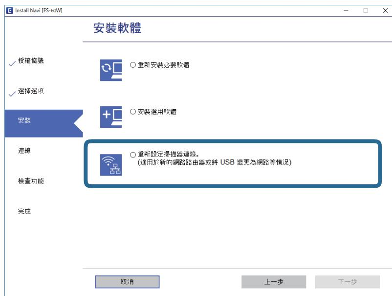
選擇 安裝軟體 畫面中的 [重新設定印表機連線。(適用於新的網路路由器或將 USB 變更為網路等情況)]，然後按下 [下一步]。依照畫面上的指示進行操作。
