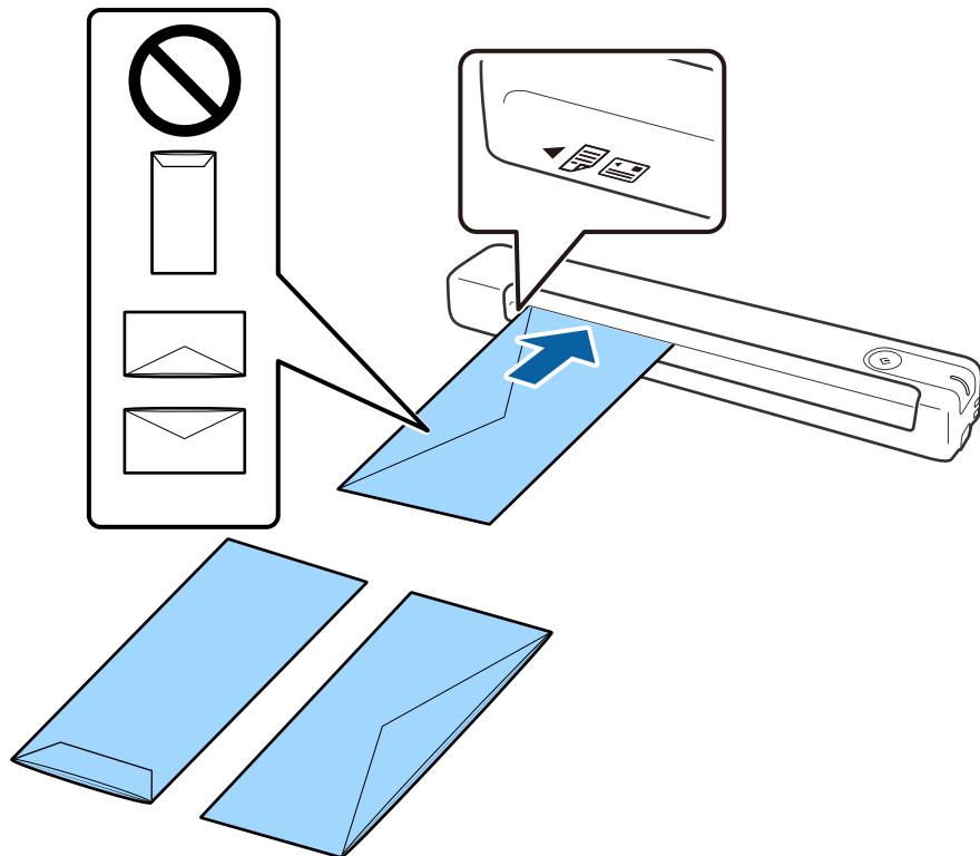
圖中所示的信封開口邊(封口側)朝上，但您亦可將信封開口邊(封口側)朝下放入掃描器。
