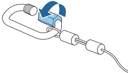
3 插入鬆開的鉤環並穿過天花板安裝座的軸端，然後鎖緊。
