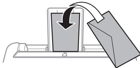
□ 請在放入前攤鬆信封，然後將邊緣對齊。堆疊的信封因空氣而膨脹時，請在放入前將信封壓平。
