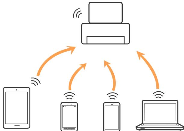
印表機可同時透過 Wi-Fi 和 Wi-Fi Direct (簡易 AP) 連接方式連接。不過，如果您在 Wi-Fi 連接方式下啟動 Wi-Fi Direct (簡易 AP) 方式的連接，Wi-Fi 會暫時斷開。
