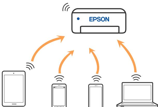
印表機可同時透過 Wi-Fi 或乙太網，以及 Wi-Fi Direct (Simple AP) 連接方式連接。不過，如果您在 Wi-Fi 連接方式下啟動 Wi-Fi Direct (Simple AP) 方式的連接，Wi-Fi 會暫時斷開。
