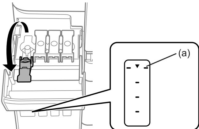
8. 將墨水瓶頂部對齊填充口，然後將其徑直插入此端口以填充墨水，直到其自動停止在最高標示線處。
