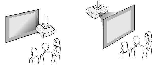
根據您所使用的安裝方式，請從投影機安裝選單，選擇正確的投影方式選項。如有需要，請在投影機的顯示選單中調整選單旋轉設定。
