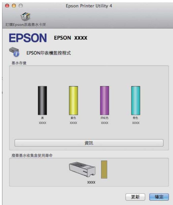
您也可在列印前利用此工具檢查墨水匣。EPSON印表機監控程式會顯示墨水匣開啓時的狀態。若要更新墨水匣狀態的資料，請按下[更新]鍵。
