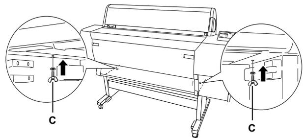
5. 鬆開前方的滑輪及固定旋鈕，並將印表機移到使用位置 (指短距離移動)。將印表機移動到使用位置後，請固定滑輪並調整固定旋鈕。
