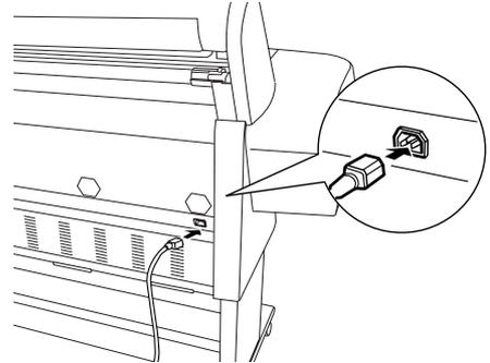
2. 如圖所示，將隨箱所附的三個固定扣環安裝在印表機的後方，然後將電源線穿過印表機後方的固定扣環。
