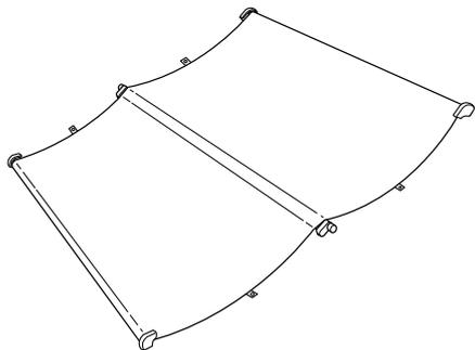
5. 握住後方柄桿，使它穿過水平橫桿的下方。握住後方柄桿及連接處 (H)，並如圖所示，將後方柄桿轉個方向。然後將紙張收集籃兩側的連接處卡入後方柄桿。
