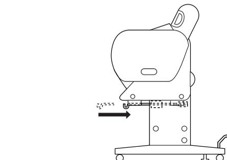
3. 同樣地，將紙張收集籃的長掛鉤完全地插入及安裝在下方的位置。
