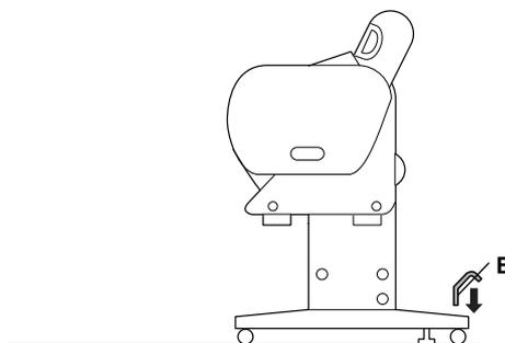
2. 將紙張收集籃的短掛鉤完全地插入及安裝在兩側支撐架最上方的位置。
