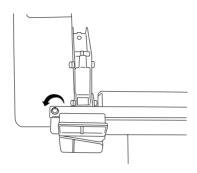
3. 滑動並取出在裁切刀單元中的刀片,然後裝上新的刀片。
