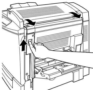
4. 拆除印表機右側護蓋，然後往印表機的方向推直到它發出喀嚓聲表示已經確實地闔上。
