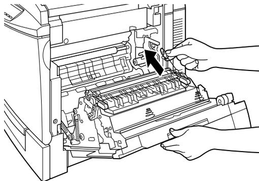
12. 如下圖所示範的方法將這塊塑膠拉環掛在印表機內側的掛鉤上。
