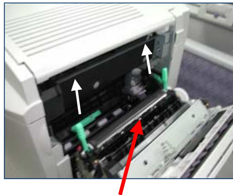
將轉換滾輪單元直接取出更換
