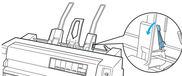
3. 滑動右邊紙張邊緣定位器，讓它邊緣與自動送紙槽上的標示對齊。然後將固定鎖調整桿往後壓便可以將紙張邊緣定位器固定在該位置上。接著，依照想要使用列印的紙張寬度移動左邊的紙張邊緣定位器。
