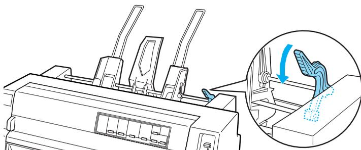
2. 將紙張邊緣定位器固定鎖調整桿往前扳鬆開固定鎖。
