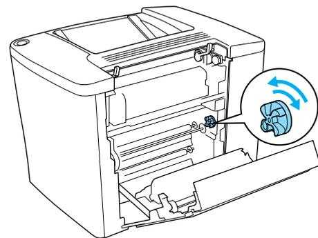
6. 如下圖所示，將調整桿向下壓，關閉印表機的紙張路徑。
