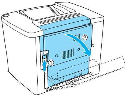
2. 如下圖所示，打開進紙路徑滾軸上方的護蓋。用雙手輕輕地取出夾紙，請小心，不要撕破紙張。
