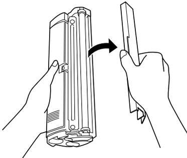
7. 如下圖所示，將碳粉匣完全推入插槽中。
