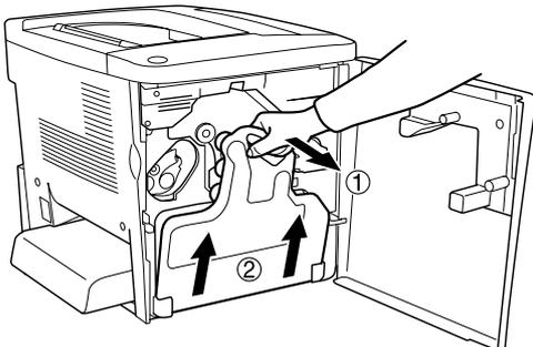
3. 將調整桿 ① 向上旋轉至鬆開的位置。然後握住感光滾筒綠色的把手 ② (依圖示箭頭方向上下壓住卡榫)，再向外取出感光滾筒。
