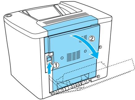
2. 如下圖所示，打開進紙路徑滾軸下方的護蓋。用雙手輕輕地取出夾紙，請小心，不要撕破紙張。
