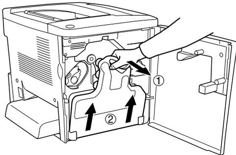
3. 如下圖所示，取下碳粉收集器上的 2 個蓋子。再將此 2 個蓋子鎖住碳粉收集器的開口。
