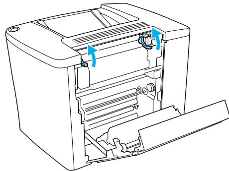
5. 如果您以順時針的方向轉動調整鈕，則夾紙會從上方出紙槽退出。如果您以逆時針的方向轉動調整鈕，則夾紙會從 AB 護蓋處退出。
