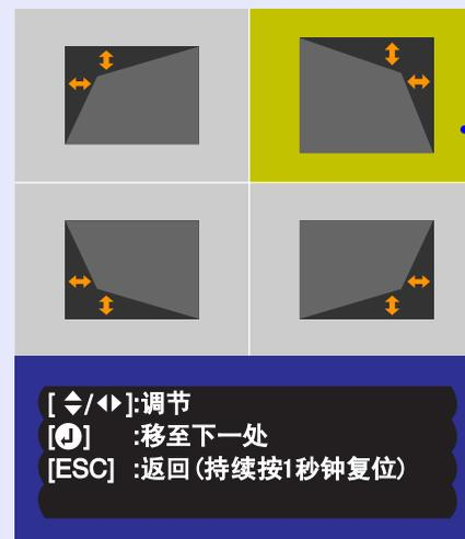
3 按遙控器上的 [△]、[▽]、[◀] 和 [▶] 鈕校正角度位置。您也可以傾斜遙控器上的 [⏭] 鈕校正角度位置。
