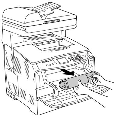
5. 從包裝袋中取出新的碳粉匣，再依下圖所示輕輕地搖晃碳粉匣。
