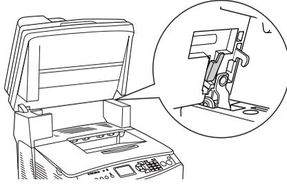
3. 將護蓋 B 上的延伸托盤推回。
