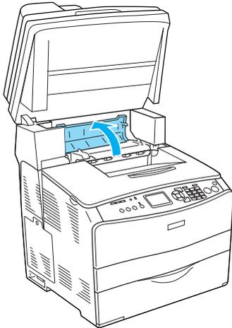
4. 請依下圖所示，用手扳起綠色凸桿以托住加熱器護蓋，然後小心地取出夾紙。請小心不要將夾紙撕破。
