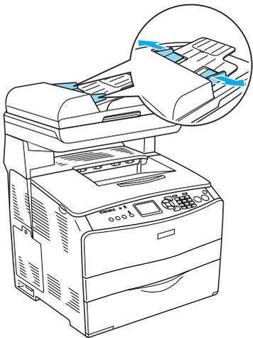
2. 將整疊文件的掃描面朝上，放入自動進紙器直到抵住底部為止，再調整“紙張邊緣定位器”，使其靠齊文件的邊緣。
