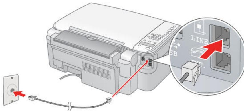
2. 將隨機所附的電話線插入電話機的连接埠中，再將電話線的另一端插入 SCX5700F 的“EXT” 連接埠中。
