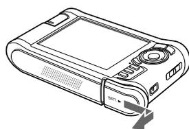
2. 依電池貼紙上的箭頭方向，將電池放入電池插槽中。
