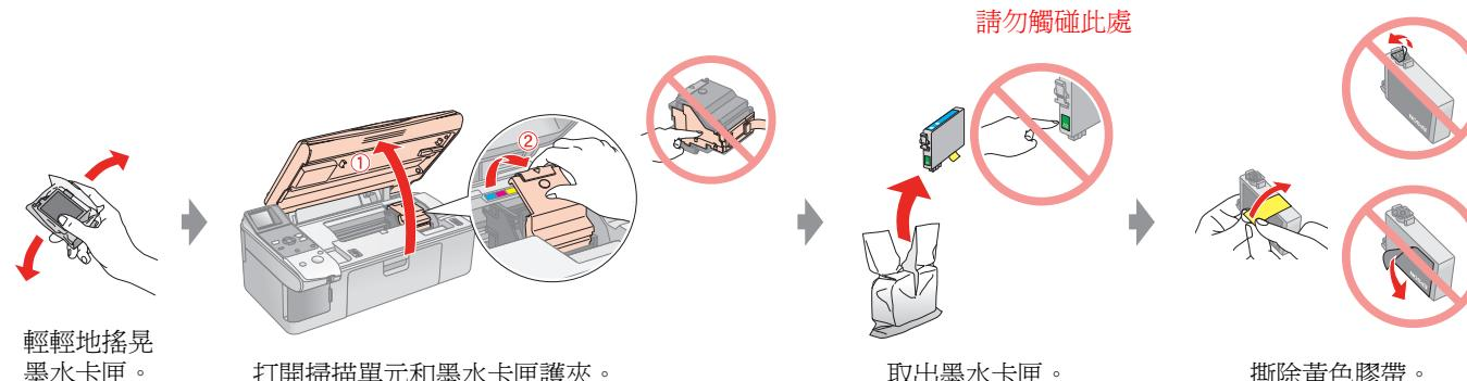
注意：為了維持墨水卡匣列印穩定性，墨水卡匣是以真空包裝的。請在安裝墨水卡匣時，才可打開墨水卡匣的包裝袋。
