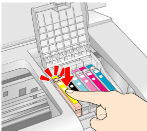
10. 當您更換完墨水卡匣後，請闔上墨水卡匣護蓋和印表機上蓋。
