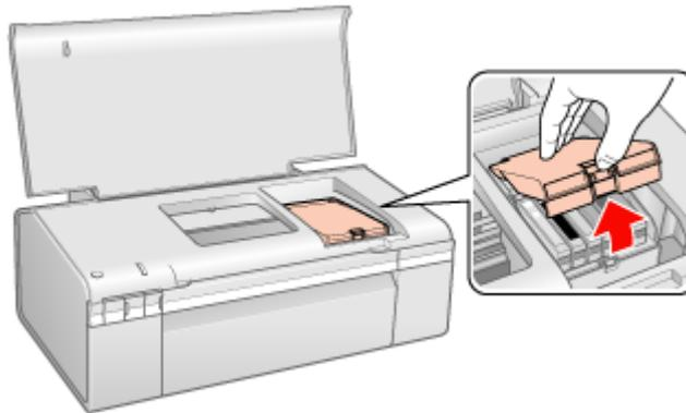
7. 壓住需要更換的墨水卡匣後側的卡榫。將卡匣從印表機中取出並妥善處理。
