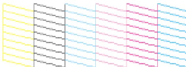
若列印的線段有任何部份遺漏了，如下圖所示，這就表示噴嘴阻塞或印字頭歪了。
