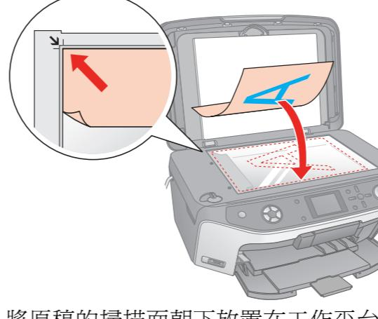
將原稿的掃描面朝下放置在工作平台上，並靠齊工作平台的左上角。
