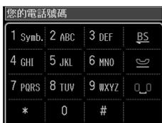
2. 使用數字鍵盤和控制面板上的其他按鍵，輸入您的電話號碼（➡ 第 5 頁“在傳真模式下使用控制面板按鍵”）。您最多可輸入 20 個數字。
