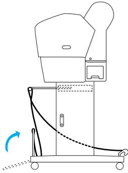
9. 如圖所示，將進紙支撐薄片鉤住紙張收集籃的中間橫桿 (將可移動的掛鉤 (a) 掛在中間的橫桿上，再將固定的掛鉤 (b) 掛在後方的橫桿上)，讓支撐薄片沿著收集籃的內部表面懸掛著。
