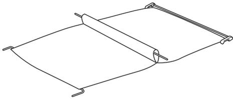
3. 如圖所示，握住後方橫桿，將它穿過水平橫桿的下方。
