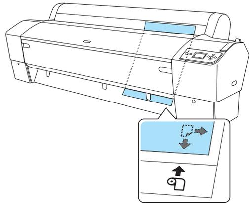
5. 將紙張調整桿切換至“Secured”位置。液晶面板會顯示“PRESS PAUSE BUTTON”訊息。
