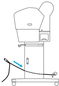
4. 旋轉後方紙張收集籃的接頭，將沒有連接布的橫桿捲入。請如圖所示，將支柱卡榫插入腳架上的凹槽中。
