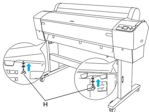
5. 鬆開前方的輪子及固定旋鈕，然後將印表機移到要使用位置（短距離移動）。將印表機移動到使用位置後，再固定輪子並調整固定旋鈕。
