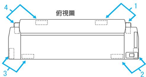
4. 使用蝴蝶螺帽、彈簧墊圈、墊圈 (H) 來固定印表機的底部及腳架。
