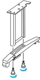
3. 如圖所示，將底部水平橫桿插入左右兩側的基座，並用六角扳手 (G) 鎖緊橫桿上的軸環 (K) 和橫桿螺絲 (I)，以固定橫桿。
