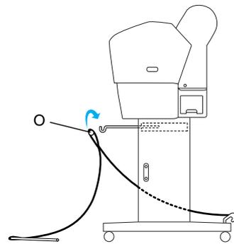
7. 請如圖所示，將下方橫桿插入腳架底部的凹槽中。
