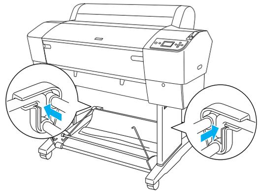
3. 旋轉紙張收集籃前面的接頭，將沒有連接布的橫桿捲入，如圖 (N) 所示。
