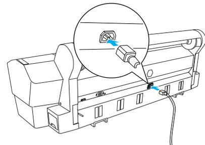
3. 將電源線穿過印表機背面的固定扣環。電源線可以繞過左側或右側。
