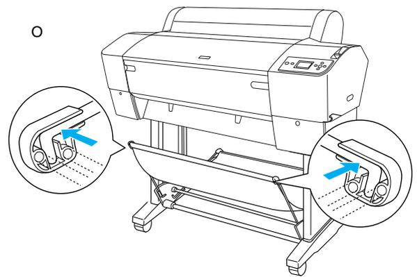
4. 當您要向前或向後饋入紙張時，請如圖所示，將 2 個紙張支撐板安裝在印表機的底部。
