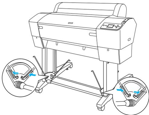
2. 將紙張收集籃後面的接頭卡入腳架後面收集籃掛鉤的頂端。請確定接頭的銜接方式與位置與圖示相同。
