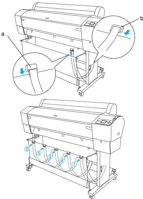
10. 當您要向前或向後饋入紙張時，請如圖所示，將 5 個紙張支撐板安裝在印表機的底部。
