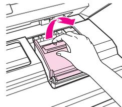
5. 壓住墨水卡匣後面的卡榫，將墨水卡匣從印表機中取出。
