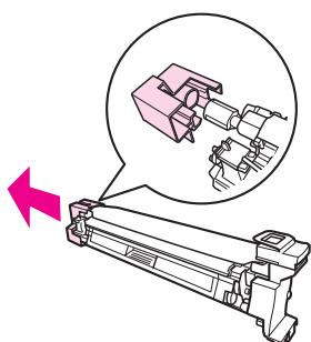
5. 依照印表機內的感光滾筒標示，找出感光滾筒的安裝位置。將感光滾筒上的色彩標籤印表機上的標籤，然後插入感光滾筒。。
