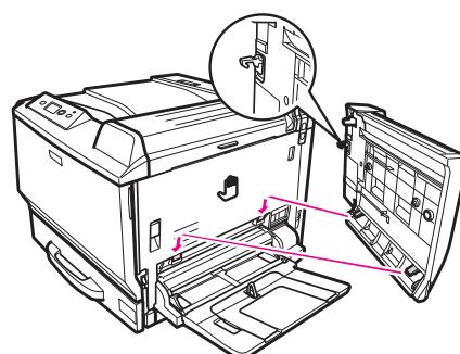
10. 請將雙面列印單元護蓋上方的手把向下拉，並在打開的同時用手握住雙面列印單元。
