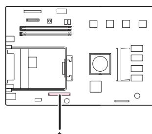
\* CompactFlash 記憶卡插槽
