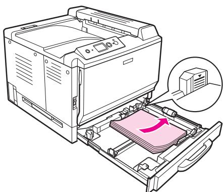
7. 壓下卡榫並移動紙張邊緣定位器，使其靠齊紙張的邊緣。
