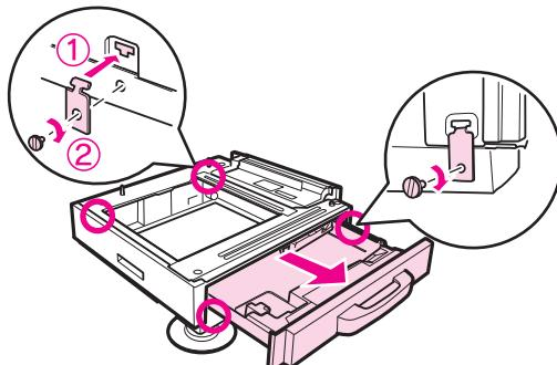
7. 旋轉調整器來調整高度，防止印表機底座移動。
