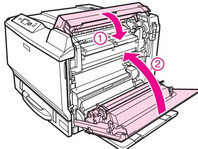
9. 請依下圖所示，安裝雙面列印單元，並確定雙面列印單元有鉤住印表機的卡榫。
