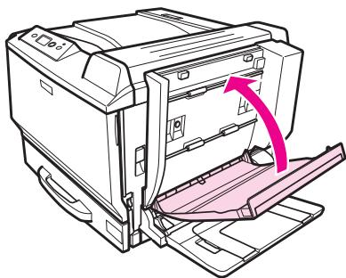
7. 握住雙面列印單元的同時，拉起固定卡榫並打開護蓋 A。
