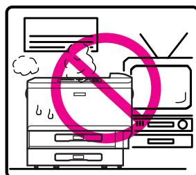
請勿將印表機放置在靠近電視機、收音機、除濕機、冷暖氣機出風口、或電扇直接吹拂的地方
