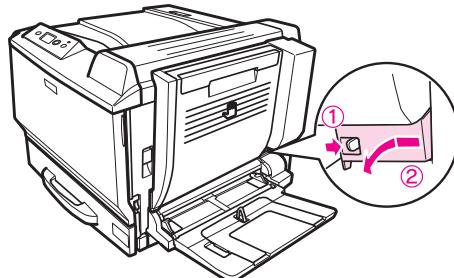
3. 拔下印表機插槽上的雙面列印單元連接線。
