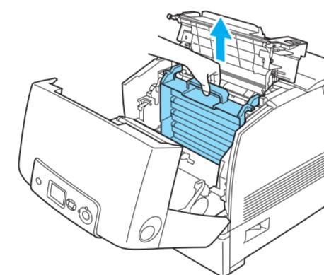
5. 從包裝中取出新的感光滾筒，並移除感光滾筒背面的保護裝置。
