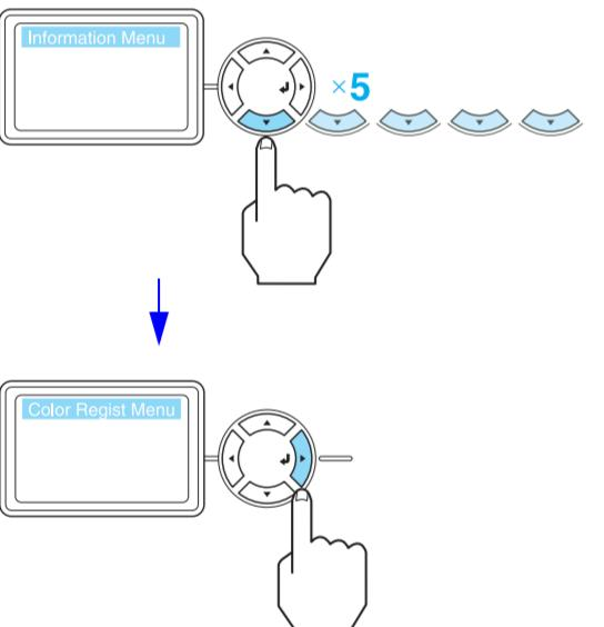
3. 使用『▲向上』鍵，直到液晶面板顯示需要校正的顏色“XXXX Resist”（XXXX 設定），再按下『Enter』鍵。
