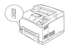
2. 將電源線插入印表機的電源插座中。再將電源線的另一端插 入有接地的電源插座中。
