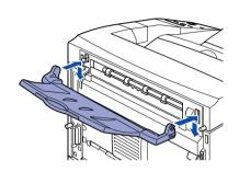
2. 將調整桿往上推(如圖 ①)。 再向外拉出延伸支撐板(如圖 ②)。
