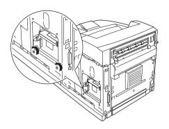
2. 將硬碟裝置的連接線連接至電路板上(如圖①)。 再依照圖②、圖③的步驟,將硬碟裝置插入印表機中。
