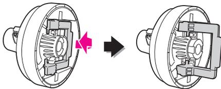
**7** 將滾筒紙轉接軸貼緊滾筒紙的兩端。然後拉下兩側的滾筒紙轉接軸固定桿，加以鎖定。
