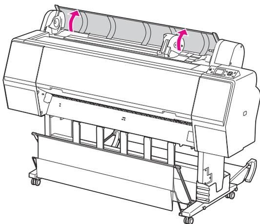
**3** 若要解開轉接軸支撐架，請將轉接軸支撐架的固定桿用力向下壓。然後握住把手將轉接軸支撐架移至左側。
