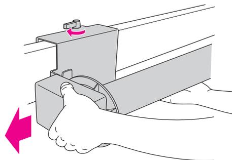
**4** 從可移動裝置及驅動裝置上的輪緣，移除收紙器滾軸。
