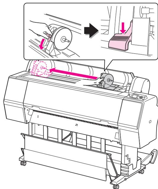
**4** 將紙張滾筒放置於印表機上方的溝槽中。
