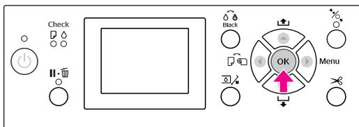
“電源”燈號開始閃爍，並啟動印字頭清潔（需要 2 至 13 分鐘）。“電源”燈號亮起時即結束清潔。
