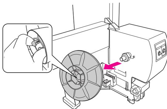
**2** 將輪緣顛倒，讓直徑較小的卡榫面向外側，然後壓下卡榫將輪緣裝在驅動裝置上。
