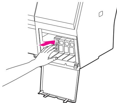
6 小心地將需要更換的墨水卡匣從插槽直直地向外拉出。
