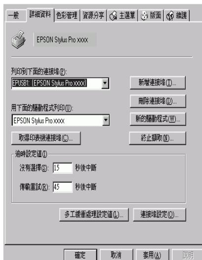
若 **EPUSBX: (EPSON Stylus Pro 4400)** 或 **EPUSBX: (EPSON Stylus Pro 4800)** 有顯示在“**列印到下面的連接埠**”清單欄位中，則表示 USB 印表機裝置驅動程式和印表機軟體都已安裝正確。若沒有顯示正確的連接埠，請繼續進行下一個步驟。
