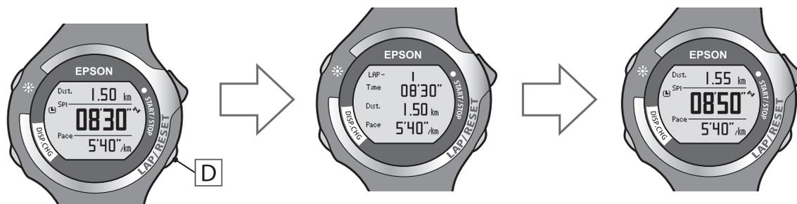
分圈畫面顯示的測量資料，分別為分圈編號、分圈時間、分圈距離、分圈配速。
