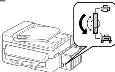
**7** 將大容量墨水槽從印表機上取下，並將其平放，然後確定栓緊大容量墨水槽上的瓶蓋。
