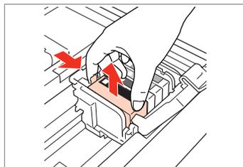
用手壓住墨水卡匣的卡榫，取出墨水卡匣。
