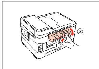
若要放低或收起控制面板，請將控制面板後方的調整桿向外拉，然後向下壓低。只要抬起面板，即可調高高度。
