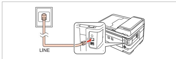
將電話線從電話壁式插孔連接至[LINE]連接埠。
